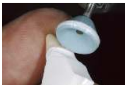
図7 マージン縁端にふれないように、その上側を切削しているところ。コーピングとポイントには再々水分を含ませる。
