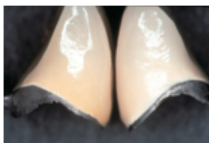
図2 銀による黄変。左：銀含有合金使用で黄変したクラウン。右：黄変していないクラウン。
