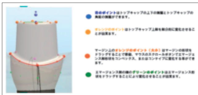
図12 アバットメント形状をデザイン。ポイントをつまんだり、ドラッグしたりすることでデザインを調整できる。
